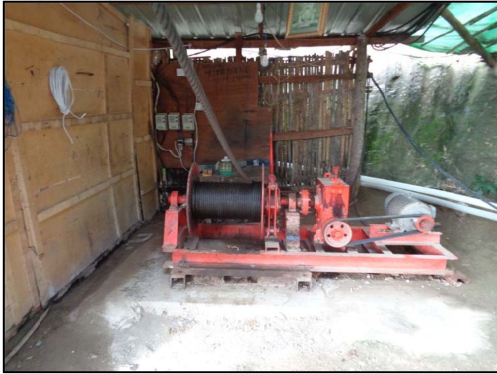
ပုံ(၁၂) အင်းသားများဆင်းတက်ပြုလုပ်ရန်နှင့် သတ္တုရိုင်း၊ စွန့်ပစ်ကျောက်များ သယ်ထုတ်ရန် အသုံးပြုသည့် Winch-Motor
